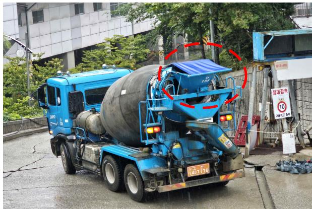
그림 3-9. 운반차량 호퍼 덮개 설치 예시
