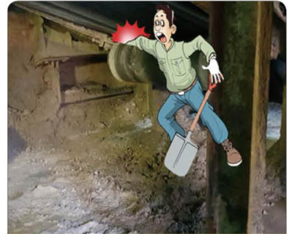
컨베이어 벨트와 드럼 사이에 끼임(사망 1)
