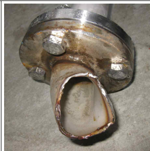
구 톨루엔 저장탱크 이전 설치 용접 중 폭발로 2명 사망('11.7.10, 경기 시흥)
