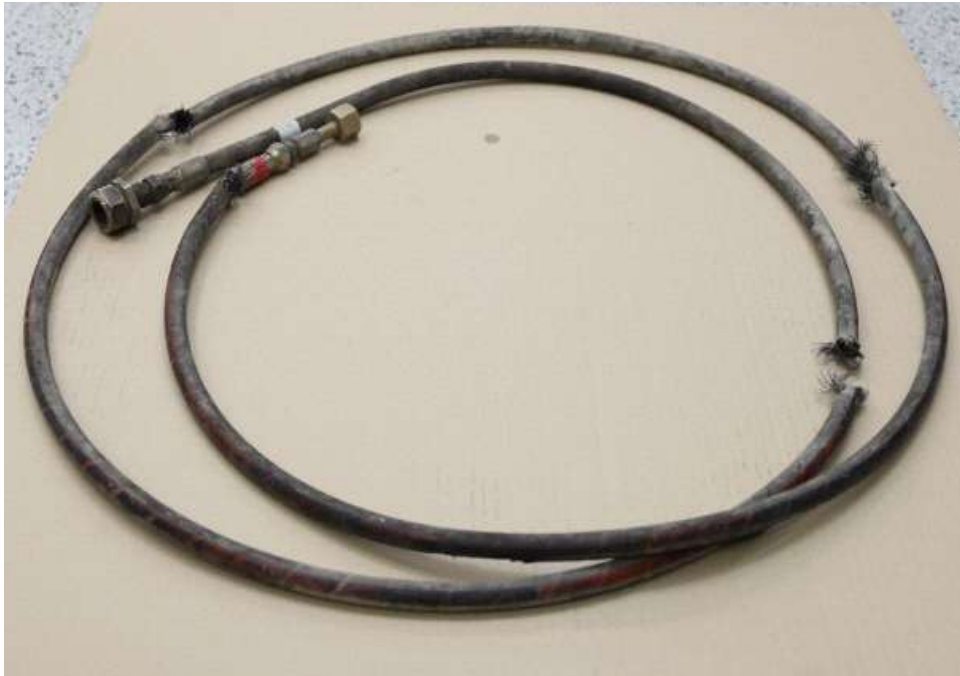
33. 고압호스 파손전 형상 재연
