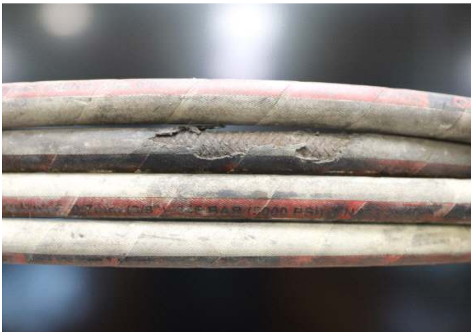
36. 고압호스 피복 손상면 비교
