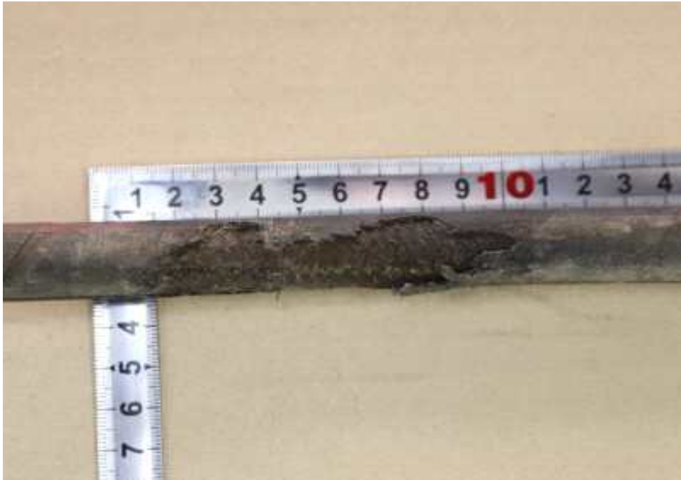
35. 고압호스 피복 손상면
