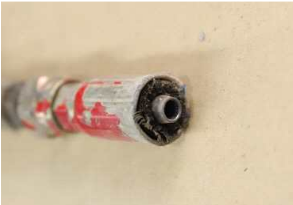
32. 산소용기 연결부 고압호스 절단면
