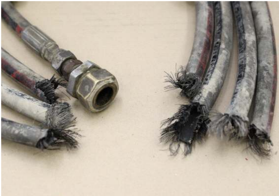
34. 고압호스 파손단면 전체
