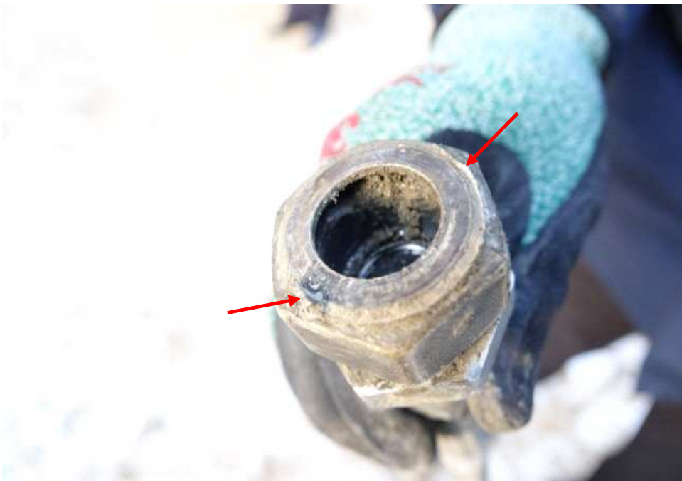
14. 사진 13의 말단부 확대 / 파손흔적
